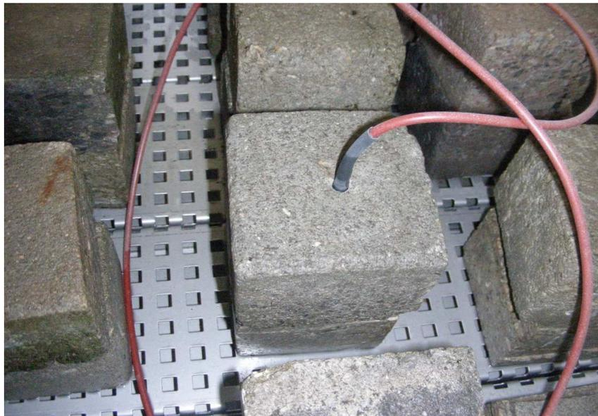
Abbildung 11: Der Innenbehälter der Flutungsoption mit Referenzfühler
