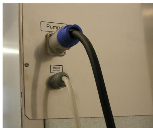
Abbildung 6: Anschluss für die Pumpe an der Rückseite des Slabtesters
