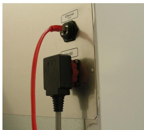
Abbildung 7: Anschlüsse für das Motorventil und für das Netzwerk an der Rückseite des Slabtesters
