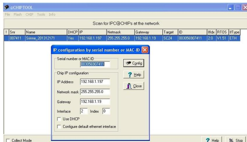
Abbildung 18: Konfiguration des Schleibinger Gerätes für eine direkte Verbindung zwischen PC und Gerät mit dem Hilfsprogramm chiptool
