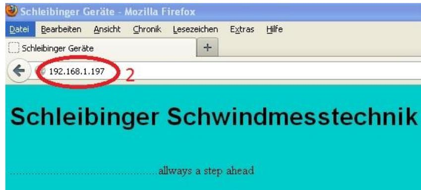
Abbildung 16: Zugriff auf das Schleibinger Gerät mit einer festen IP Adresse
