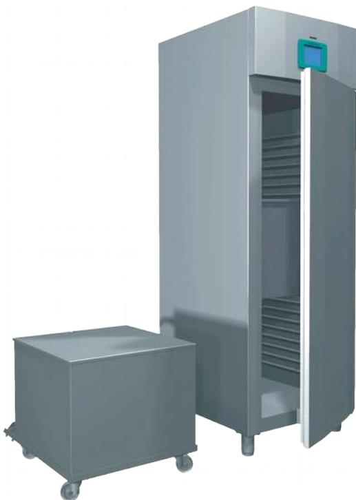
Zusätzlich mit der Option **“Frostprüfung mit Flutung”** sind automatische Frost-Tau-Zyklen zum Prüfen von Natursteinen, Gesteinskörnung, Fliesenkleber und anderen Baumaterialien gemäß folgenden Normen möglich:
